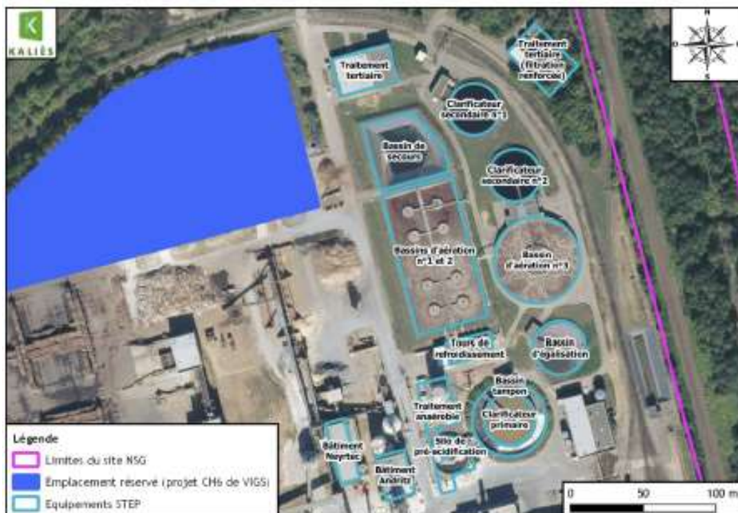
Figure 2 - Vue aérienne de la STEP de NSG
